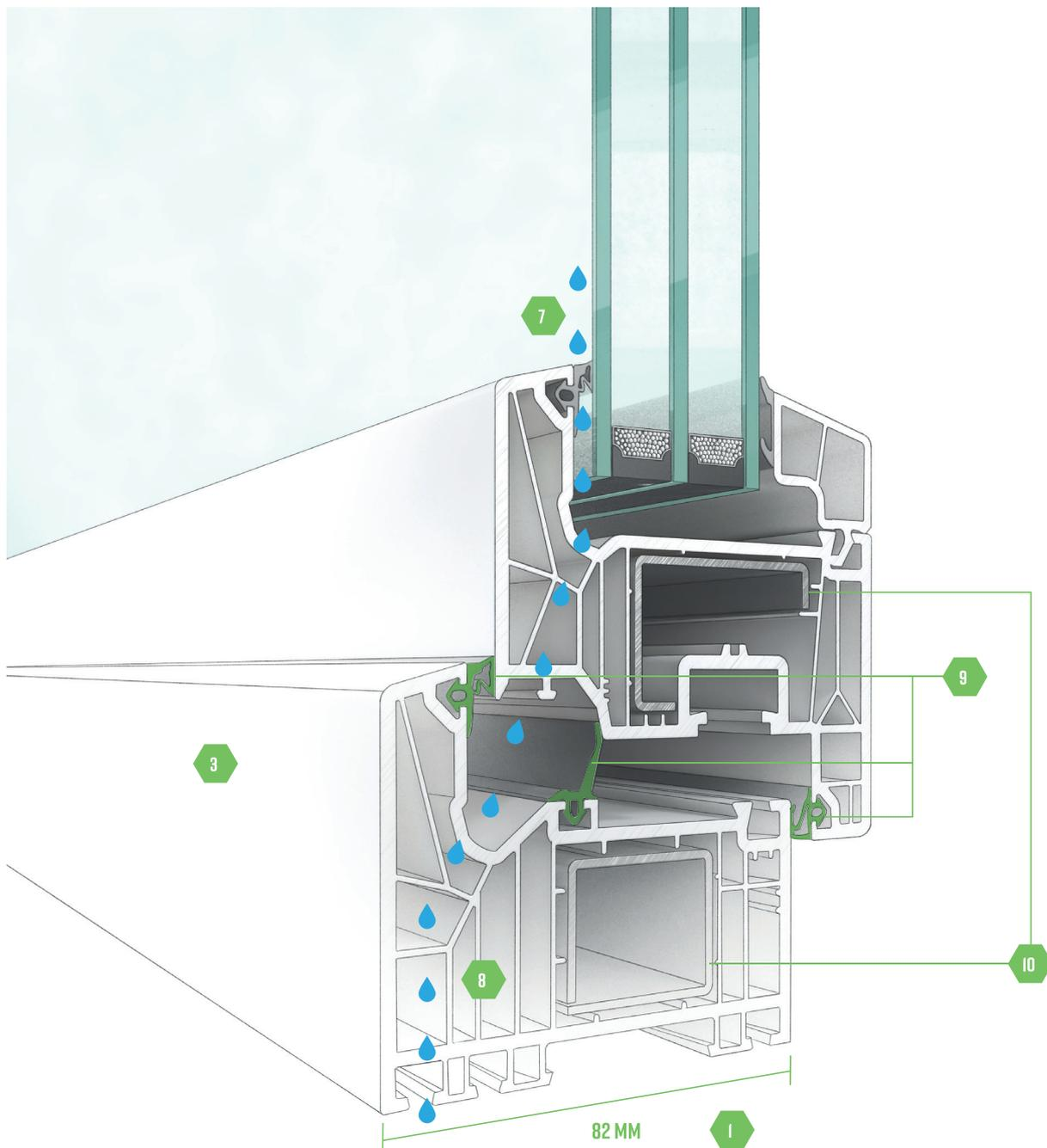
Le profilé innovant Living répond parfaitement aux nouvelles normes en matière d'isolation thermique et convient pour les maisons à basse énergie. Équipé d'un système anti-infractions, il vous apporte confort et sécurité au sein de votre bâtiment. Son design droit répond aux exigences d'une architecture moderne.
