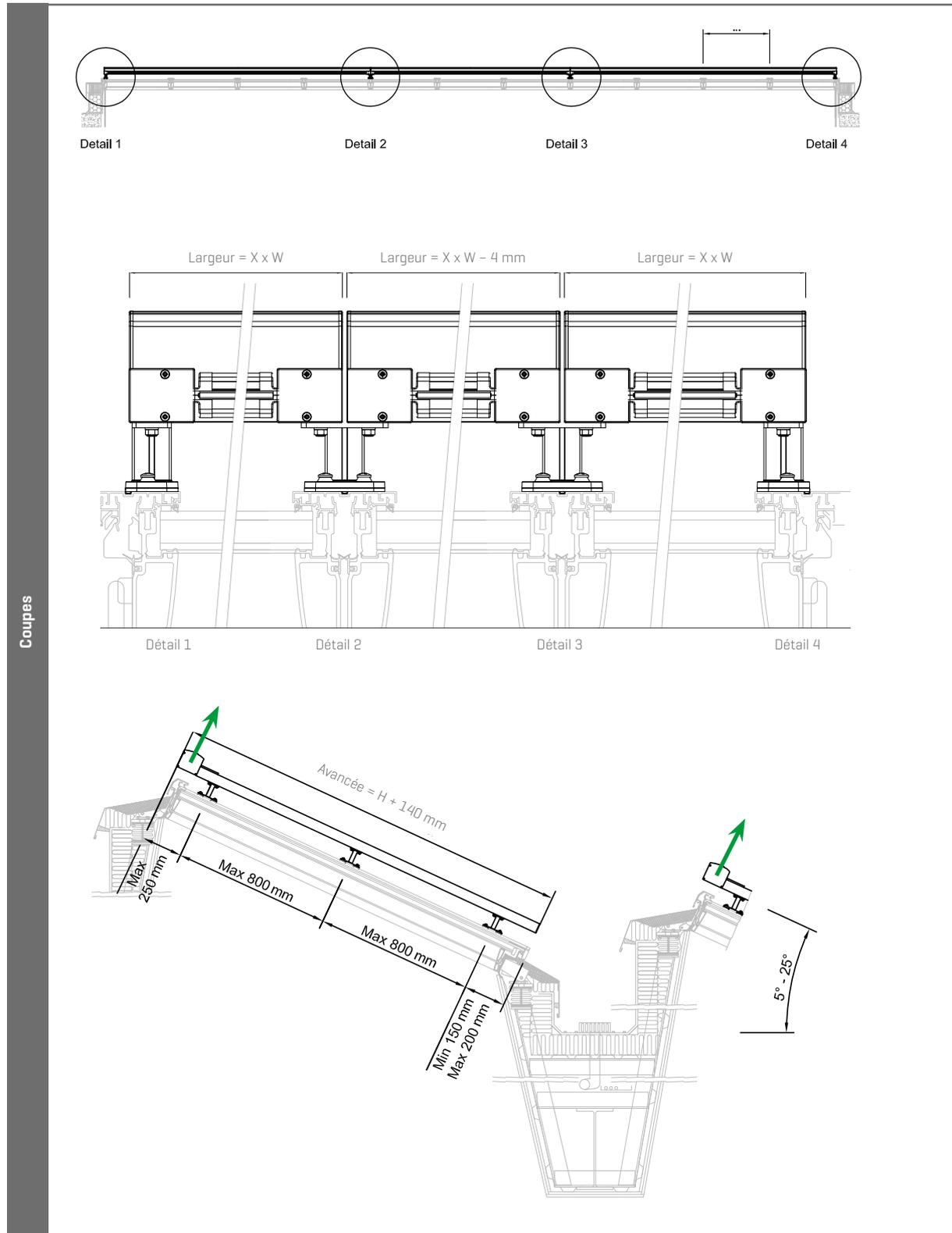
Regardez votre Topfix VMS dans la direction de [dé]montage du tube d'enroulement [←] ceci détermine le choix du passage de câble à gauche ou à droite.
