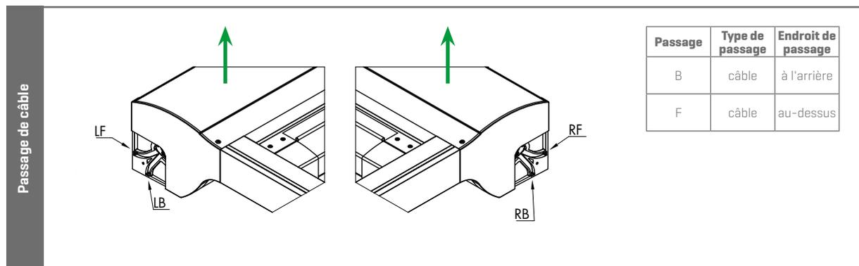
Regardez votre Topfix Max F dans la direction de (dé)montage du tube d'enroulement (→) ceci détermine le choix du passage de câble à gauche ou à droite.
