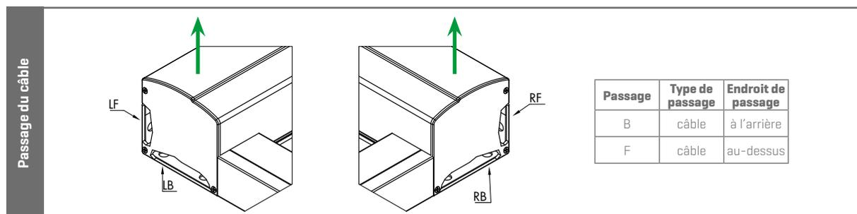
Regardez votre Topfix VMS dans la direction de [dé]montage du tube d'enroulement [ → ] ceci détermine le choix du passage de câble à gauche ou à droite.
