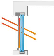
Le contrôle des gains solaires est exprimé par la valeur  $g_{tot}$  ou le facteur total de pénétration solaire. Cette valeur est le pourcentage total d'énergie qui pénètre à l'intérieur par une fenêtre équipée de protection solaire. Ceci indique donc l'efficacité de la protection solaire.
