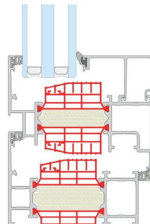
Dormant P-19-A120 avec une profondeur de 82mm
