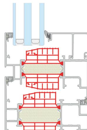
Dormant P-19-A100 avec une profondeur de 91 mm
